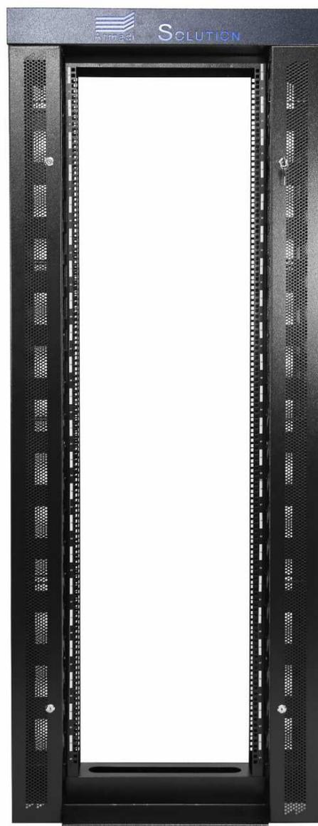
As guias verticais direita e esquerda compostas por guias frontal e traseira unidas entre si e ao rack através de parafusos. Cada guia tem a profundidade 150mm e largura de 130mm, totalizando unidas a profundidade de 300mm, a sua altura é definida pela quantidade de Us do rack.
